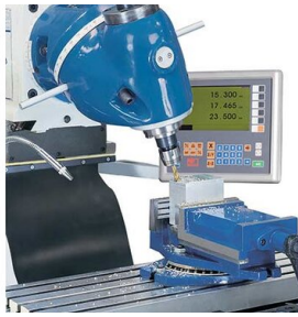
Tête de fraisage pivotante sur 2 plans
